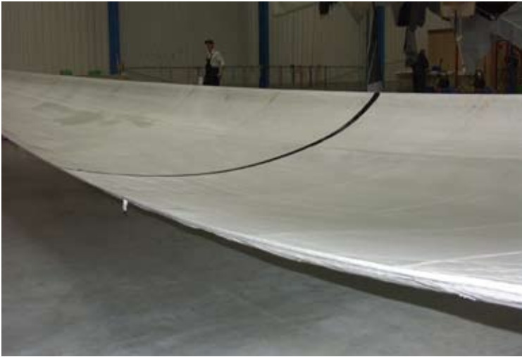
Das Achterliek der Rollgenua wurde besonders hoch belastet und ist vollkommen ausgeleiert. Von der ursprünglichen Harzung des Tuches ist nichts mehr übrig.
