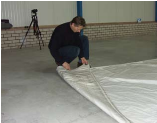
Zunächst kontrolliert man jedes Segel auf etwaige Schäden wie durchgescheuerte Nähte oder Risse im Tuch – diese werden in Absprache mit dem Eigner gegebenenfalls noch vor dem Reinigungsprozess behoben.
