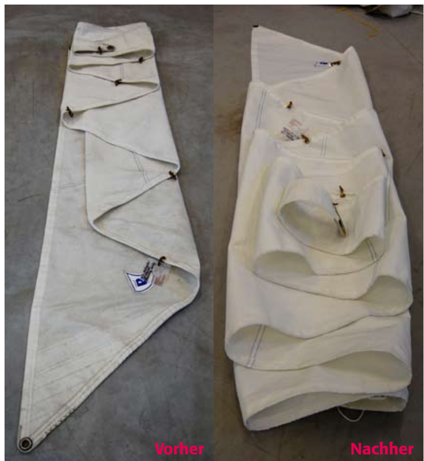
An dieser Fock ist zu deutlich erkennen, wieviel steifer das Tuch nach der Behandlung geworden ist. Und das Segel sieht nicht nur aus wie Neuware – es fühlt und hört sich auch so an.
