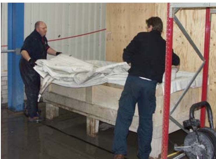
Das aufgetuchte Segel wird in ein kontrolliert temperiertes Bad gelegt, in welchem es zwischen 12 und 24 Stunden ruht. Waschmittelreste und Schmutzpartikel werden anschließend abgespült.
