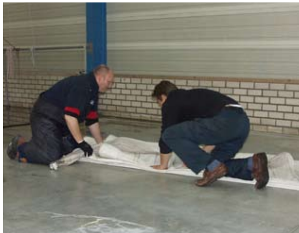
Anschließend wird das Segel sorgfältig aufgetucht. Eine Vorbehandlung ist nicht erforderlich – die Entfernung von Schimmel, Grünalgen und sonstigen Verschmutzungen überlässt man der nachfolgenden Wäsche.
