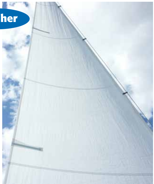
War das Achterliek der Fock zuvor nur mit einer stark gespannten Liekleine zu bändigen, steht es nun wieder ruhig. Auch die Diagonalfalten im Segel sind verschwunden.
