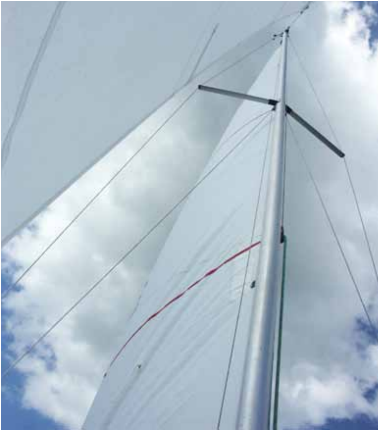
Die Profile gestalten sich deutlich flacher und harmonischer als vor der Behandlung – sowohl die Fock als auch das Großsegel lassen sich besser trimmen und behalten auch bei mehr Wind ihr Profil.
