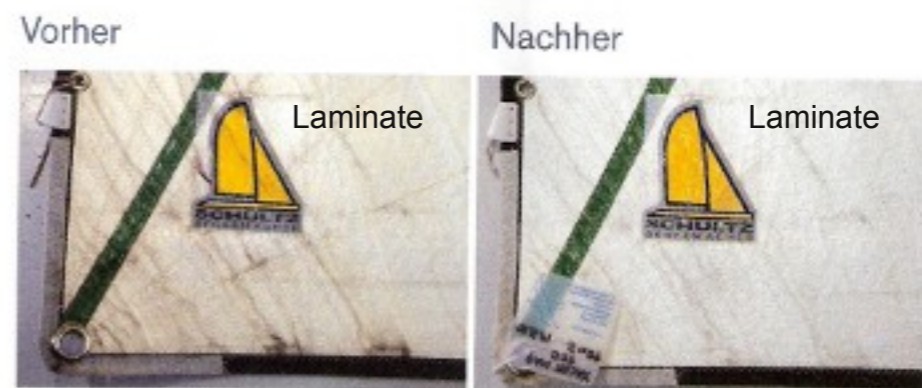
Vorher Das weiter außen aufgerollte Schothorn der Genua zeigte sich stark verschmutzt Nachher Erfolgreiche Reinigung. Die Flecken sind fast vollständig verschwunden
