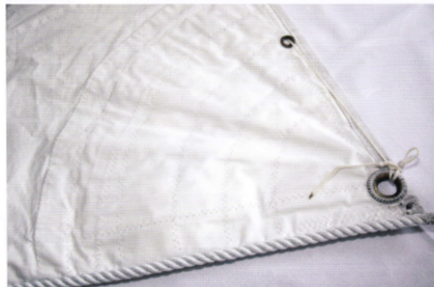
Das alte Großsegel sieht nach der Behandlung aus wie neu. Ob sich das Verfahren bei so alten Segeln lohnt, ist aber fraglich, weil diese technisch weit vom Leistungspotenzial aktueller Segel entfernt sind und die Festigkeit des Garns nachgelassen hat. Bei neueren Segeln kann eine Regenerierung aber eine lohnende Investition sein.
